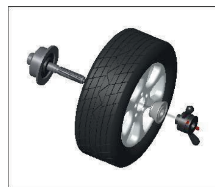
Rad-Hauptwelle – geeigneter Konus (kleiner Kopf nach innen) – Schnellspannmutter
