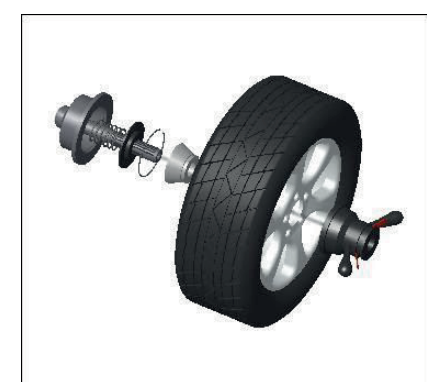
Geeigneter Konus auf die Hauptwelle (großer Kopf nach innen) – Rad – Schnellspannmutter
